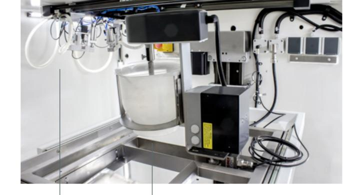
Automatische Dosierung von 2 Komponenten. Automatisches, programmierbares Abwiegen der Komponenten und gleichzeitiges mischen und Abgießen.
